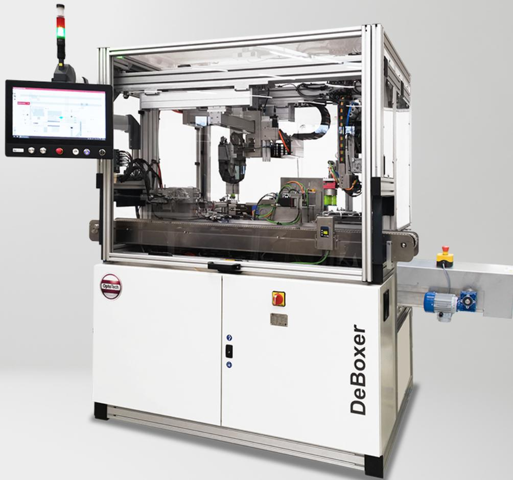
Der neue automatische DeBoxer wurde speziell zum Auspacken halbfertiger Linsen entwickelt. Je nach Kartonart kann diese Maschine bis zu 300 Gläser/h auspacken. Darüber hinaus kann der DeBoxer optional mit 2 Auslaufbändern zur direkten Abfalltrennung von Karton und Kunststoff ausgestattet werden.
